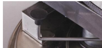
Hebel zur Betätigung der Filterreinigung (Rüttler und gleichzeitiges Ausblasen durch Umkehrung des Volumenstroms)
